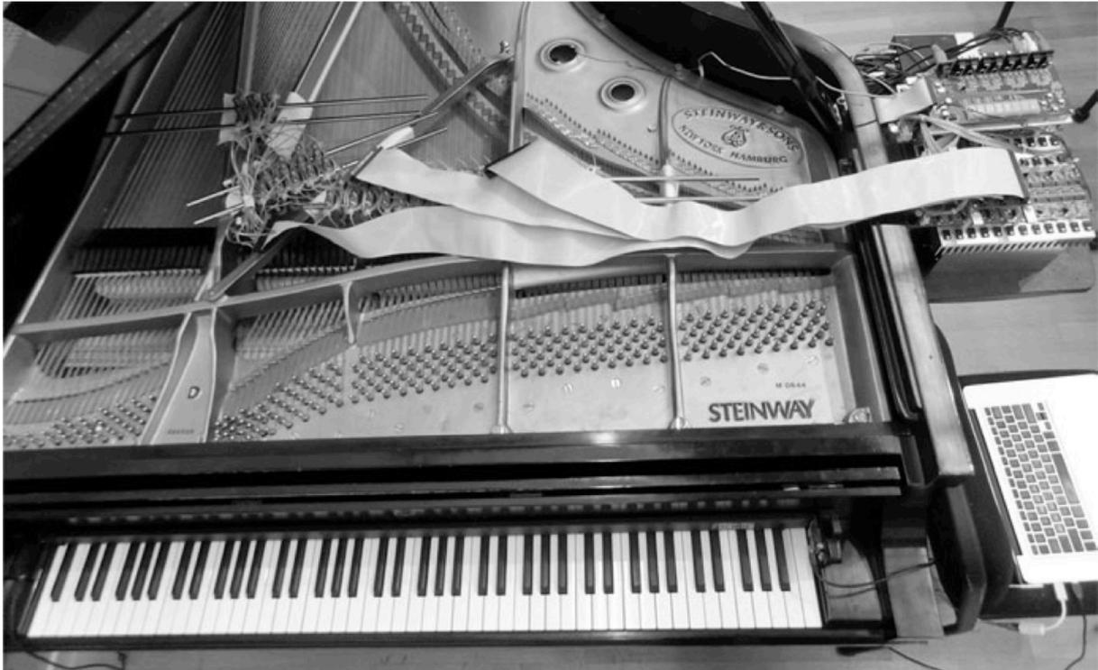
*Abbildung 1.* Das elektronisch erweiterte akustische Piano versetzt über Elektromagnete die Saiten in Schwingung (aus McPherson & Kim, 2013, S. 135).
